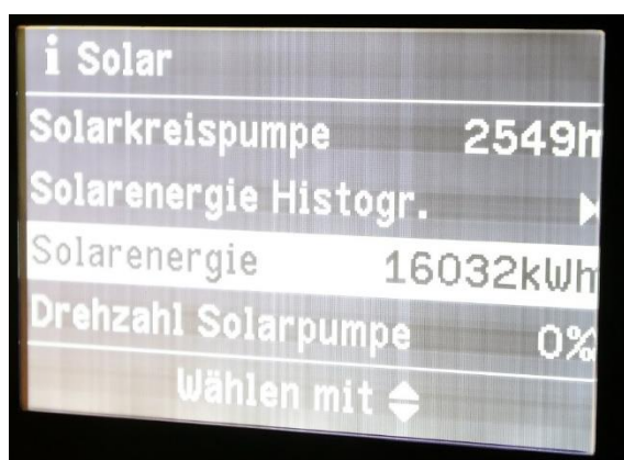
Abbildung 5: Ins Gerät integrierte Solarertragsanzeige einer 6m 2 Flachkollektor-Anlage nach 1,5 Jahren Solarthermie-Nutzung. Zu erwarten wäre ein Solarertrag von etwa 3.000 kWh (Quelle: co2online )
