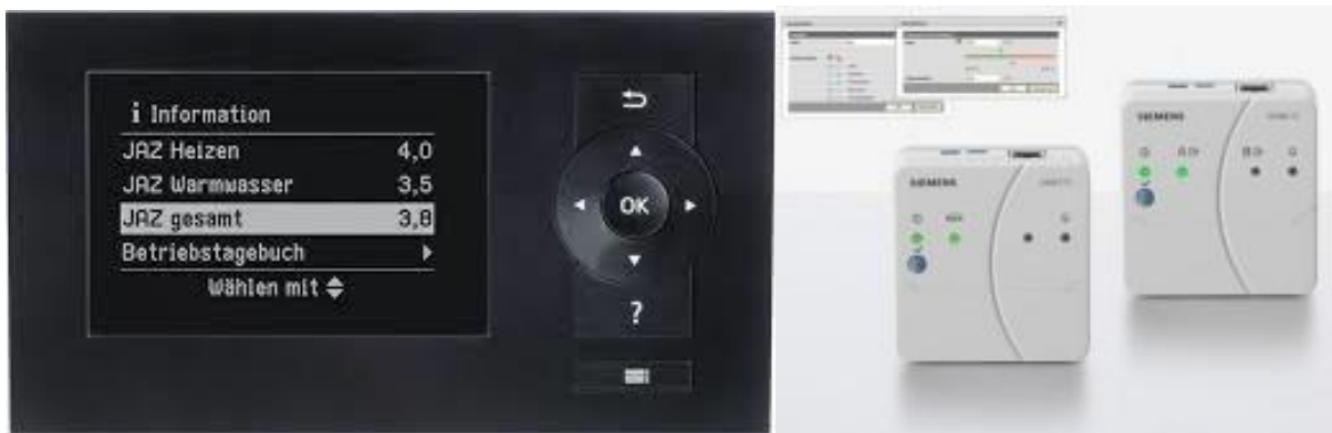
Abbildung 2: Beispiel für bereits umgesetzte Effizienzanzeigen: Bild links: Anzeige Jahresarbeitszahl bei Wärmepumpen, Quelle sbz-online.de / Viessmann; rechts: „Energieindikator“ 3 (Quelle: Siemens)
