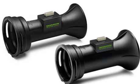
Abbildung 3: Mikrothermische Gaszählermodule (Quelle Fa. Sensirion) erreichen MID-Genauigkeitsklasse 1,5 und sind nach EN 14236 für Erdgas, Typ H und L zertifiziert.
